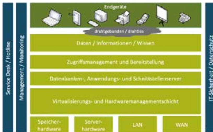
Abbildung 6: Schichtenmodell der im Schulcampus zum Einsatz kommenden IT-Komponenten
